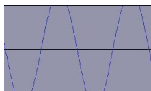
Sinuston verzerrt durch Clipping
